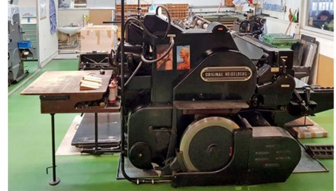
Heidelberg-Buchdruckmaschine von 1959; nach einem Umbau wird mit ihr jetzt gestanzt, geprägt und genutet.
